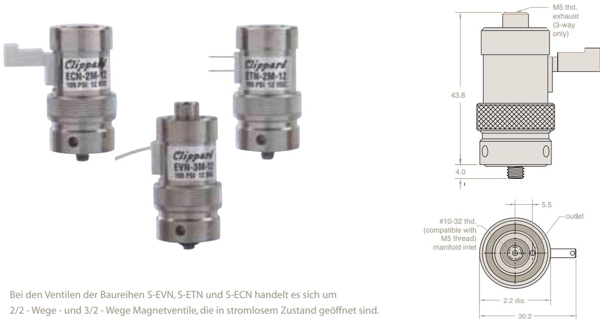
Bei den Ventilen der Baureihen S-EVN, S-ETN und S-ECN handelt es sich um 2/2 - Wege - und 3/2 - Wege Magnetventile, die in stromlosem Zustand geöffnet sind. Der Einlass befindet sich im zentralen Befestigungsbolzen, so dass die Ventile direkt – ohne externe Verrohrung - über die Montageplatte mit Luft versorgt werden.
