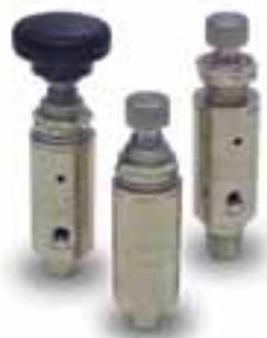
Die Druckregler stehen in rücksteuerbarer und nicht rücksteuerbarer Ausführungen zur Verfügung. Die rücksteuerbare Ausführung hält einen konstanten Druck auch dann, wenn sich die nachgeschalteten Druckverhältnisse im System ändern. Wenn der Druck aufgrund von geringerem Durchfluss steigt, öffnet der Kolben des Regelventils und der Druck wird in die Atmosphäre abgegeben. Auf diese Weise erreicht man einen konstanten Ausgangsdruck.
